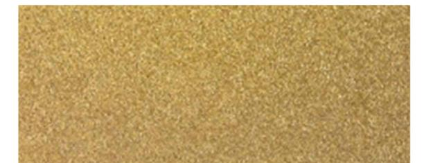
\* Resultado de la prueba: 360 horas después de exposición en cámara salina
